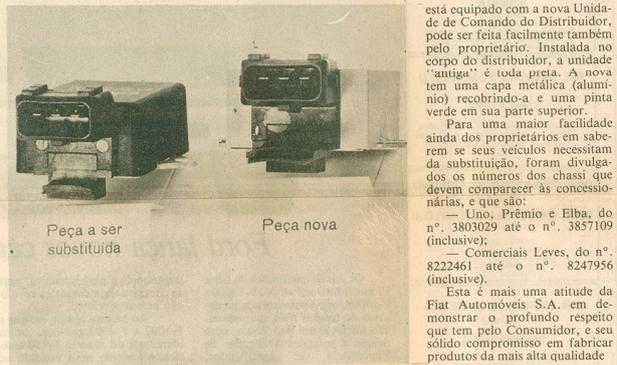
está equipado com a nova Unidade de Comando do Distribuidor, pode ser feita facilmente também pelo proprietário. Instalada no corpo do distribuidor, a unidade "antiga" é toda preta. A nova tem uma capa metálica (alumínio) recobridora e uma pintura verde em sua parte superior.
